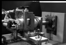
Zkouška pevnosti utahováku
