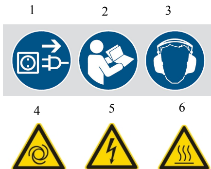
Obr. 1: Symboly (1 Vytáhněte síťovou zástrčku / 2 Dodržujte návod k použití / 3 Používejte ochranu sluchu) | Výstražné značky (4 Upozornění na automatické spuštění / 5 Nebezpečné elektrické napětí / 6 Horký povrch)
